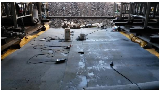
Figur 2.1.6 Värmemattorna vid utläggning efter att de täcktes med isolering, försök 3. Mätpunkternas horisontella läge markeras av de två hinkarna.
