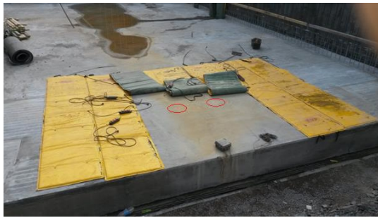
Figur 2.1.5 a) Värmemattorna innan de täcktes med isolering vid försök 2. Två markeringar för mätpunkternas horisontella läge. b) Värmemattorna täckta med betongtäckmattor.
