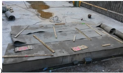
Figur 2.1.5 a) Värmemattorna innan de täcktes med isolering vid försök 2. Två markeringar för mätpunkternas horisontella läge. b) Värmemattorna täckta med betongtäckmattor.
