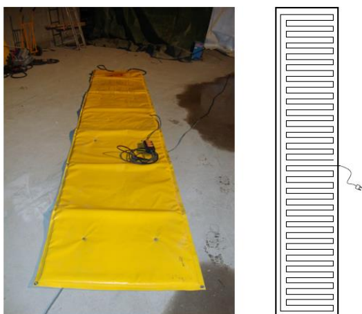
Figur 2.1.1 Värmemattan som behandlas i detta arbete. Den högra bilden visar schematiskt hur värmekablarna är dragna.
